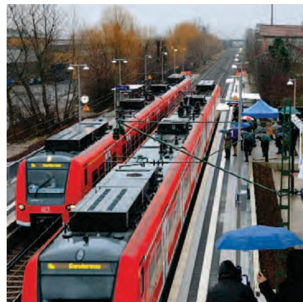
Graben-Neudorf und Germersheim elektrifiziert – zuvor konnten dort nur Dieselloks fahren. Weitere Maßnahmen waren die Anpassung der Gleis-, Oberleitungs- und Signalanlagen, Gleisabsenkungen in Brückenbereichen sowie der S-Bahn-gerechte und barrierefreie Ausbau der Bahnsteige.
