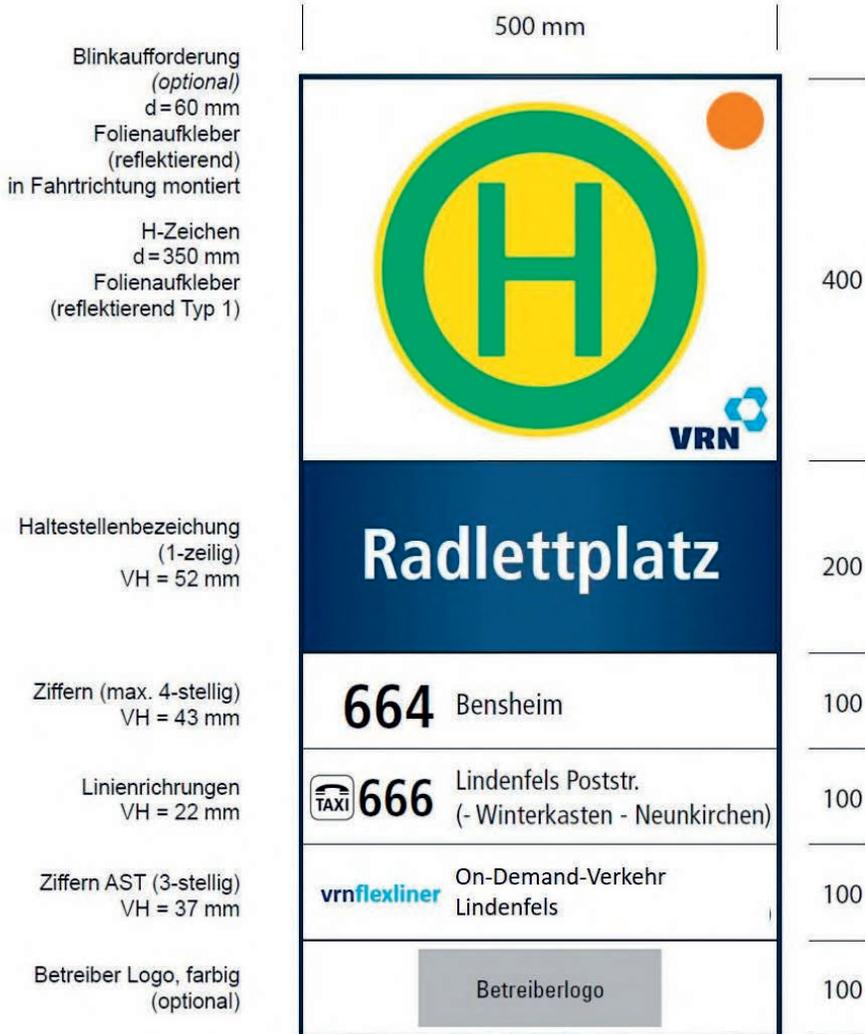
Abbildung 3.1: Wechselschildsystem mit gewölbter Oberfläche (höherwertiges System)
