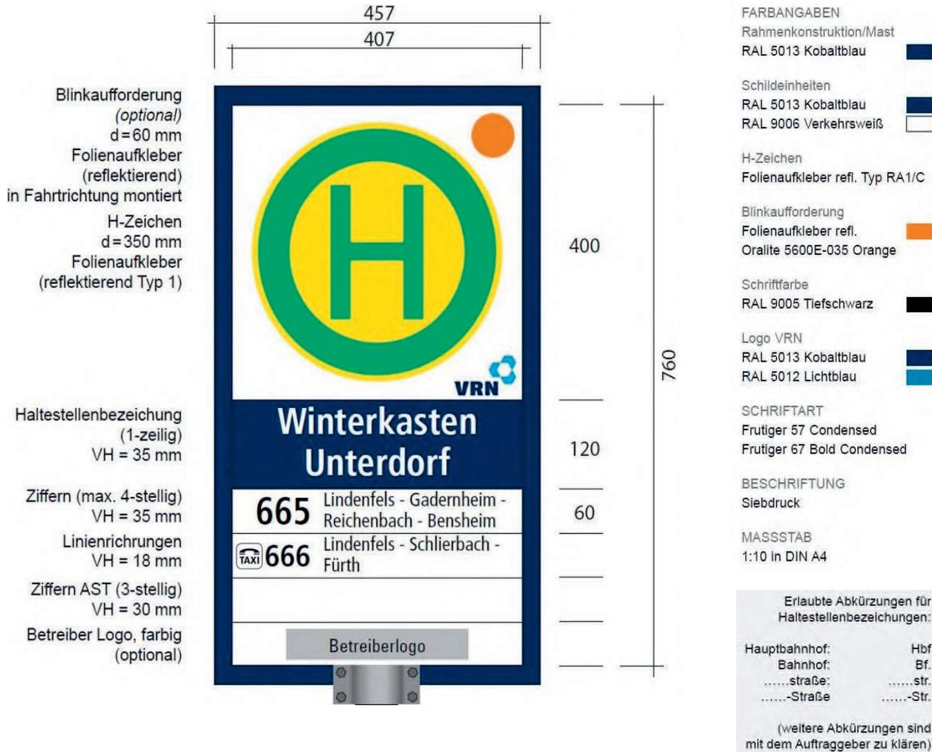
Abbildung 1.1: Wechselschildsystem (Standard)
