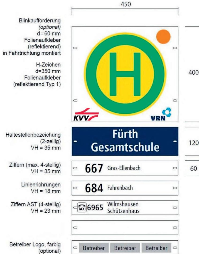
Abbildung 1.2: Wechselschildsystem (Standard)
