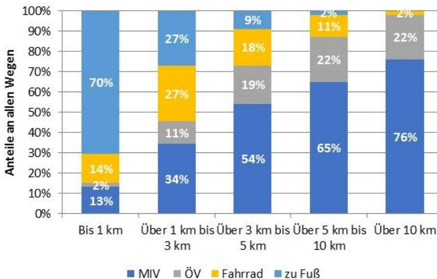
Abbildung 26: Entfernungabhängige Verkehrsmittelwahl in Mannheim<sup>33</sup>
