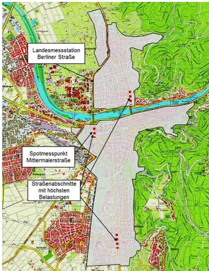
Abbildung 11: Heidelberger Umweltzone mit höchstbelasteten Straßenabschnitten und Messstellen<sup>16</sup>
