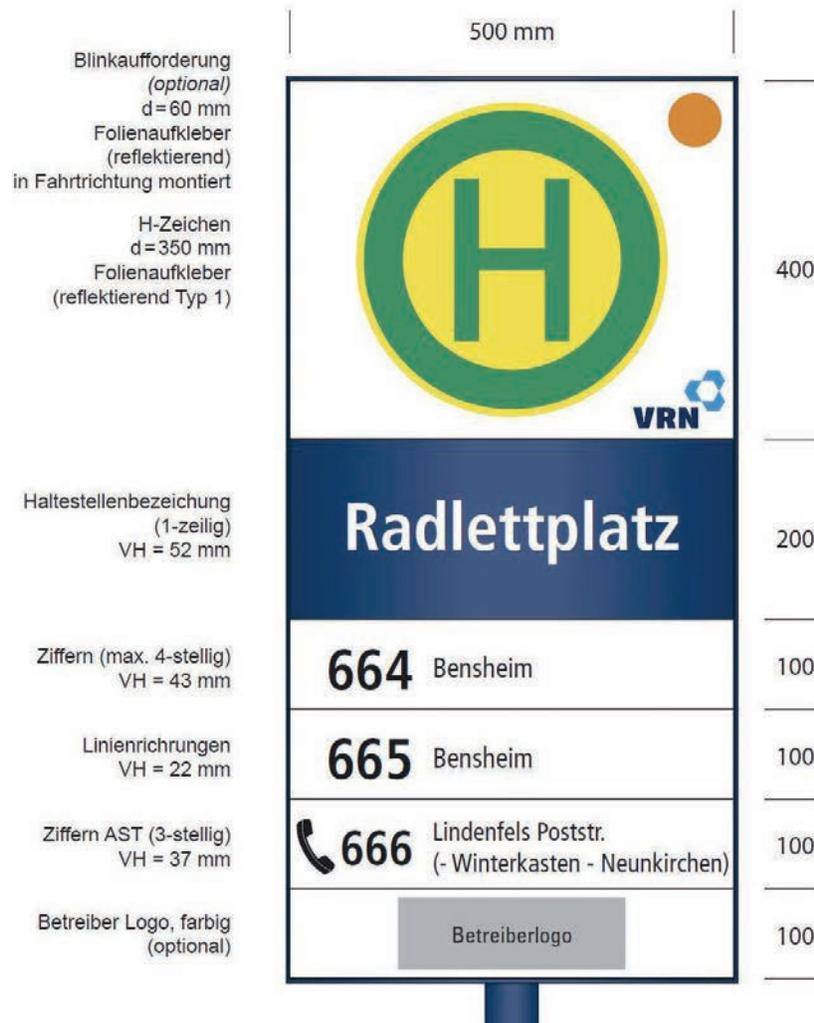
3.1 Wechselschildsystem mit gewölbter Oberfläche als Stele (höherwertiges System)
